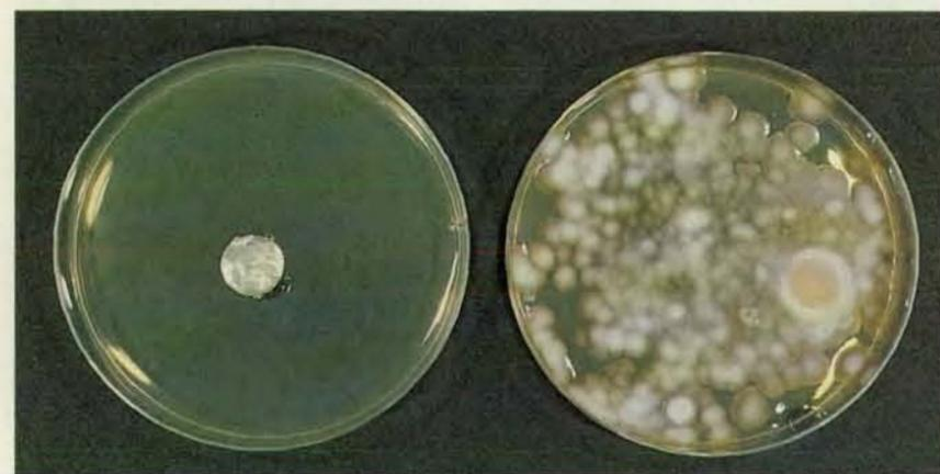
Un dischetto di alluminio, che era stato artificialmente infettato con  $10^9$  conidi di *Penicillium waksmanii*, è stato poi sterilizzato mediante esposizione a un plasma freddo di aria. Il fatto che l'aria sia in grado di uccidere, qualora venga portata in fase plasma, organismi resistenti come le spore fungine testimonia in modo eloquente la reattività e l'aggressività delle specie chimiche presenti nel plasma.
